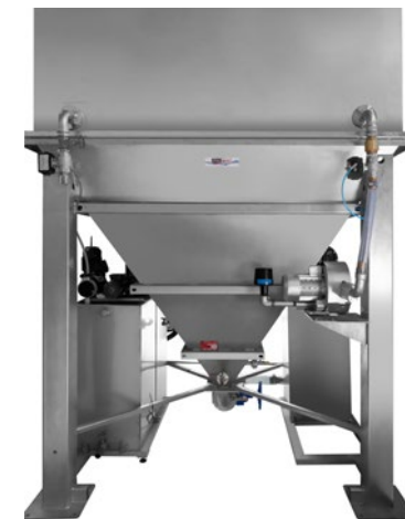
Sistema automatico programmabile di auto-pulizia dei pacchi lamellari Programmable automatic self-cleaning system for lamellar packs Automatisches programmierbares Selbstreinigungssystem für Lamellenpackungen Sistema de autolimpieza programable automático de paquetes lamelares
